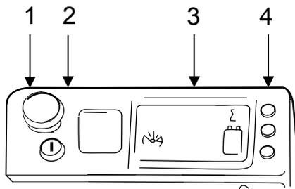
Der Stapler ist mit einem Notausschalter ausgestattet (siehe Abbildung). Notausschalter betätigen, um die Spannung in folgenden Fällen abzuschalten:
