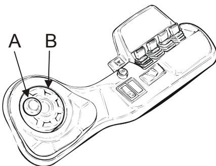
Die Lenkradsteuerung ist progressiv, d.h. das Antriebsrad des Kommissioniergerätes steuert langsamer bei geringer Bewegung des Lenkrades und schneller bei rascher Lenkradrotation. Bei Fahren mit hoher Geschwindigkeit (lange Strecken usw.) lenken Sie das Kommissioniergerät mit den Fingerspitzen an der Lenkradnabe. Bei langsamer Fahrt und beim Drehen können Sie mit Hilfe des Kreisels das Lenkrad schneller rotieren lassen.
