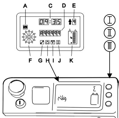
Es ist möglich, den Stapler entspr. den Wünschen verschiedener Fahrer bezüglich Geschwindigkeit, Beschleunigung usw. einzustellen. Siehe hierzu Abschnitt "Anzeigen und Programmieren". Geben Sie den Fahrer-PIN-Code mit den Tasten I-III an. Zwei Möglichkeiten sind vorhanden: bis zu drei oder bis zu zehn Fahrer.
