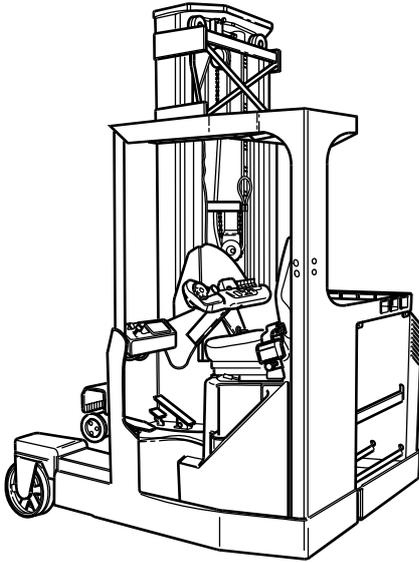
Der BT Vierwegestapler ist mit einem Fahrerplatz versehen, der speziell für effizientes Handling von langen Lasten und Palettenlasten konzipiert wurde.
