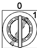
Hauptstromschalter für den Steuerstrom.
