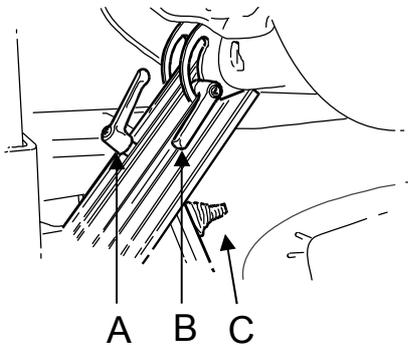
Die stufenlose Einstellung der Bedienkonsole ermöglicht eine bequeme Position beim Fahren.
