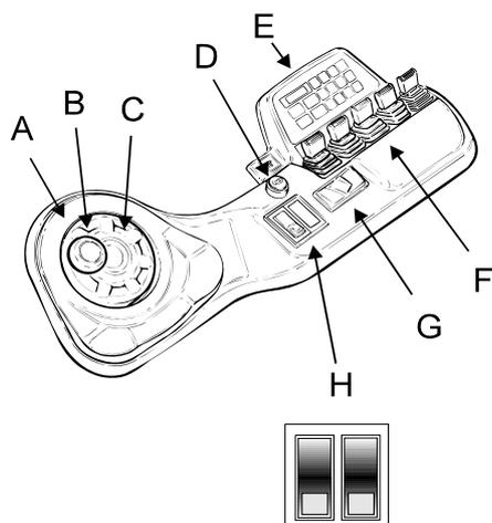
Die Lenkung arbeitet progressiv. Dies bedeutet, daß die Lenkgeschwindigkeit bei zunehmender Fahrgeschwindigkeit abnimmt (die Empfindlichkeit nimmt ab). Bei niedriger Fahrgeschwindigkeit brauchen Sie das Lenkrad nicht so oft umzudrehen wie bei hoher Fahrgeschwindigkeit.
