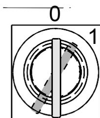
Der Stapler kann auch mit einem Auffahrsensor ausgerüstet werden. Wenn der Stapler mit einem fremden Gegenstand zusammenstößt, wird dies vom Auffahrsensor erfaßt. Ein Summmer ertönt und der Stapler kann nicht mehr gefahren werden. Die Rückstellung erfolgt mit dem Schlüssel am Armaturenbrett, der auf 1 und dann auf 0 gedreht wird.
