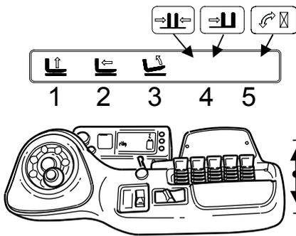
Die Bedienkonsole umfaßt maximal fünf Minihebel, mit denen alle Hydraulikfunktionen bedient werden können. Die Betätigung der Hebel wird von der Logikkarte verarbeitet, die korrekte Werte für die Geschwindigkeit des Pumpenmotors und den Ölfluß durch das Ventil einstellt. Sie verändern die Geschwindigkeit der einzelnen Funktionen, indem Sie die Hebel viel oder nur wenig nach vorne bzw. nach hinten bewegen
