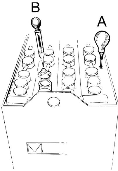
1. Alle Verschlussstopfen entfernen. Gilt nicht für Batterien mit Niveaustopfen oder zentraler Wasserauffüllung.
