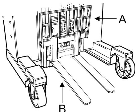
Das Lastenschutzgitter verbessert die Stabilität beim Transport hoher Lasten. Das Lastenschutzgitter ist in mehreren Höhen lieferbar, je nach Höhe der zu transportierenden Last.
