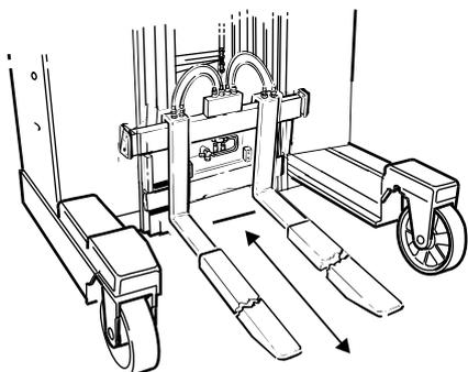
Die Teleskopgabel wird beim Stapeln mit größerer Tiefe eingesetzt. Sie eignet sich auch sehr gut als verstellbare Verlängerungsgabel.
