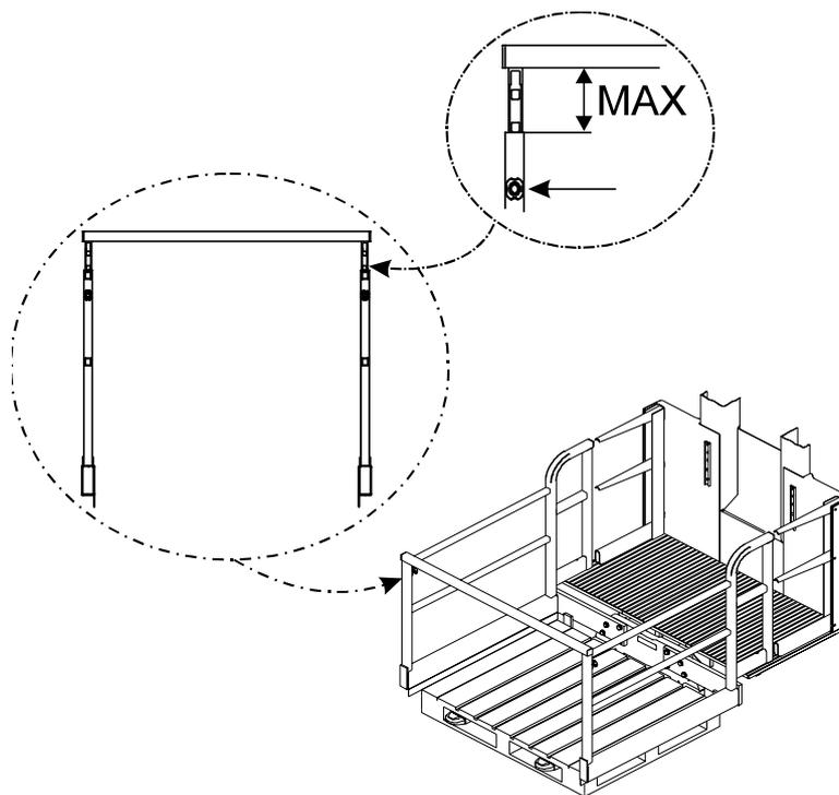
Bei der Aufnahme von größeren Lasten als 1100 mm kann die Schranke vorübergehend erhöht werden. Schranke dann wieder herabsenken.
