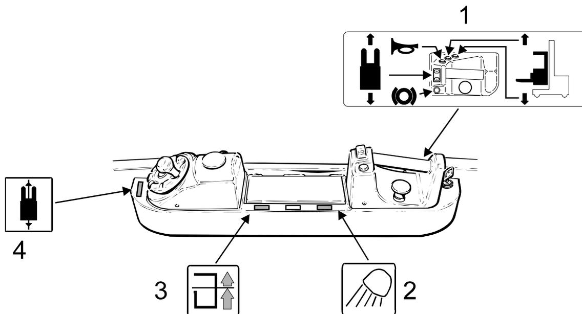
1. Vorwärts-/Rückwärtsfahren, Hupe, Bremse und Heben/Senken der Fahrerkabine
