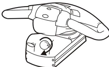
Der Stapler ist mit einem Notausschalter ausgestattet (siehe Abbildung). Notausschalter betätigen, um die Spannung in folgenden Fällen abzuschalten:
