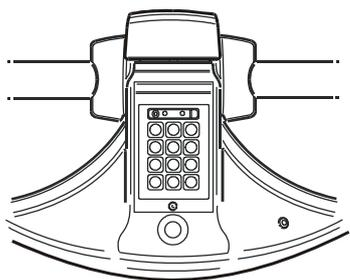
Der Stapler ist mit einer Tastatur für das Anmelden per PIN-Code ausgestattet.
