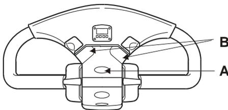
Beim Heben aktiviert dieser Schalter einen Magnetsensor, der den Pumpenmotor einschaltet, beim Senken wird der Magnetsensor zur Steuerung des elektromagnetischen Ventils aktiviert. Ein in der Hydraulikanlage integriertes Ölflußventil steuert die Senkgeschwindigkeit der Gabel.
