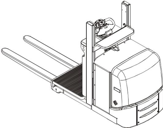
Der Stapler ist ein Kommissioniergerät zum Aufnehmen von Waren vom Fußboden sowie von der 1. und 2. Regalebene. Seine Konstruktion ermöglicht Kommissionierarbeiten unter Berücksichtigung ergonomischer Erfordernisse. Die Gestaltung des Fahrerplatzes garantiert eine bequeme und sichere Arbeitsposition und sorgt gleichzeitig dafür, dass der Fahrer den Überblick über die Arbeit behält.
