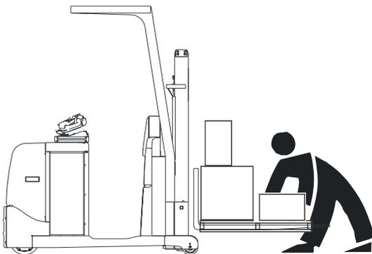
Der Stapler wurde in der Grundausstattung ausgelegt und hergestellt als Arbeitsgerät für innerbetriebliche Kommissionierung zur Aufnahme von Waren vom Fußboden oder aus der 1. Regalebene.
