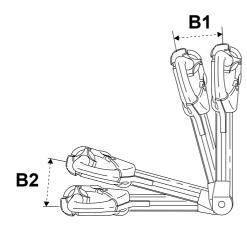
Wenn der Fahrer die Deichsel losläßt, geht dieser automatisch wieder in die obere Position (B1) zurück, d.h. in Feststellbremsstellung.
