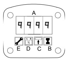
Dieses Feld zeigt normalerweise die Batteriekapazität in % an, kann aber auch Fehlercodes und Parameter anzeigen.
