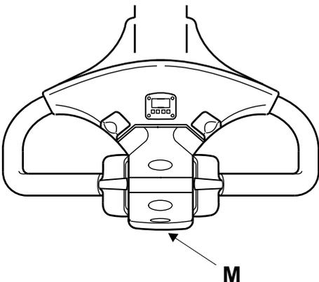
Um den Fahrer vor Quetschverletzungen zu schützen, fährt der Stapler in Gabelrichtung, wenn Schalter M betätigt wird. Wenn der Schalter nicht mehr betätigt wird, bleibt der Stapler stehen. Sie müssen den Fahrrichtungsschalter in Neutrallage bewegen, um den Stapler neu zu starten.
