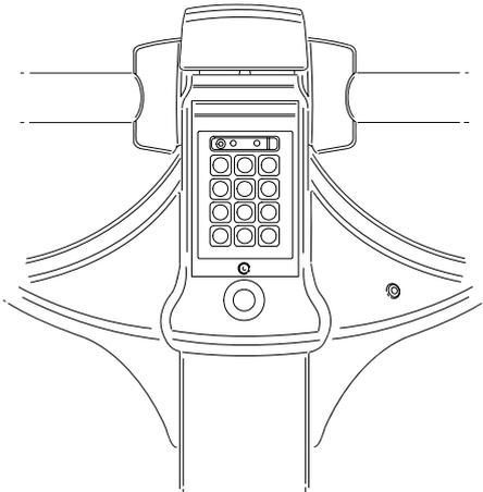
Der Gabelhubwagen ist mit einer Tastatur ausgestattet, die den Schlüssel ersetzt. Durch die Eingabe eines persönlichen Codes wird sichergestellt, dass nur autorisierte, ausgebildete Fahrer den Gabelhubwagen starten können.
