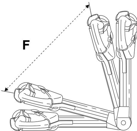
Stapler mit der Deichsel in mittlerer Position, F, fahren.
