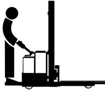
Wenn der Fahrer mit in Antriebsradrichtung geklappten Türen auf der Fahrerplattform steht, beträgt die max. Geschwindigkeit des Gabelhubwagens 8 km/h.
