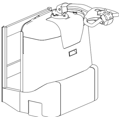
Der Stapler kann optional mit einer Version für das Gehen neben der Maschine ausgestattet werden.
