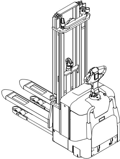
Dieses Gerät ist ein Elektro-Gabelhubwagen, der mit einer Deichsel ausgestattet ist. Der Gabelhubwagen kann wahlweise von der Fahrerplattform aus oder im Gehen gesteuert werden.
