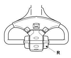
Die Fahrrichtung bestimmen Sie, indem Sie Schalter (R) in gewünschte Richtung drehen. Die Fahrgeschwindigkeit wird je nach Schalterbetätigung stufenlos reguliert.
