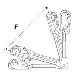
Stapler mit der Deichsel in mittlerer Position, F, fahren.
