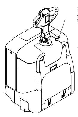
Der Stapler ist mit einem Notausschalter ausgestattet (siehe Abbildung). Notausschalter betätigen, um die Spannung in folgenden Fällen abzuschalten:
