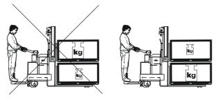
Senken Sie beim Doppelhandling die Last auf den Gablen möglichst dicht an die auf den Stützarmen aufgenommene Last ab.
