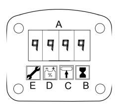
Dieses Feld zeigt normalerweise die Batteriekapazität in % an, kann aber auch Fehlercodes und Parameter anzeigen.
