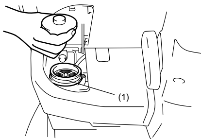
(1) Depósito de reserva
